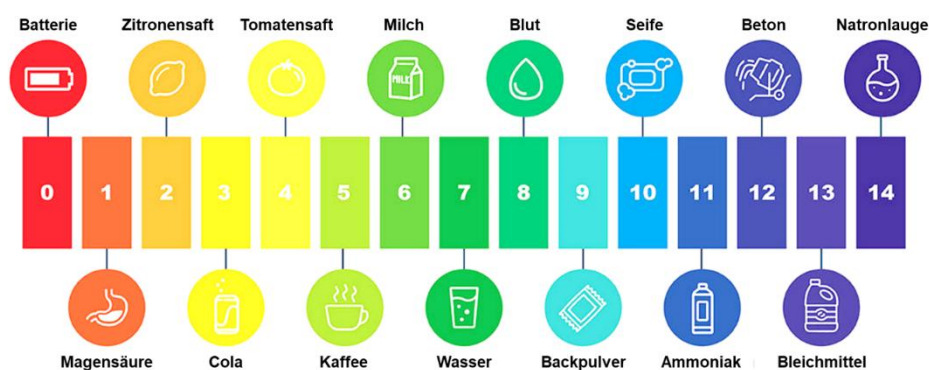
Abbildung 12: Definition der pH-Skala. Dabei gilt: \text{pH} > 7 : die Lösung ist basisch; \text{pH} = 7 : die Lösung ist neutral; \text{pH} < 7 : die Lösung ist sauer. Abbildung verändert nach [55].
